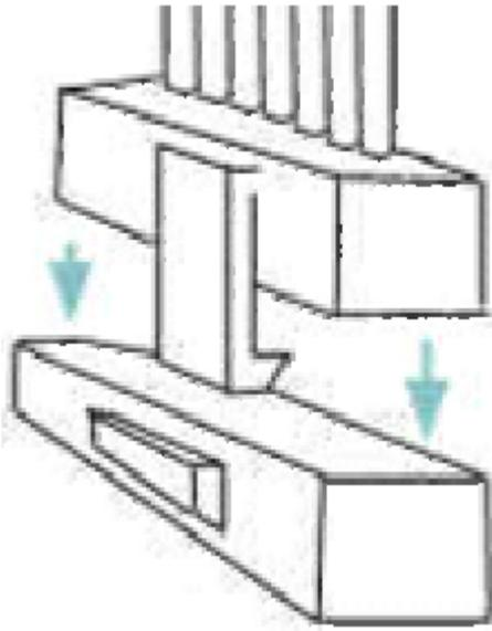
Lo último que queda por realizar es conectar los LEDs luminosos y el altavoz, estos son los cables que vienen incluidos en la caja. Habrá que enchufar los cables de la placa etiquetados con el led correspondiente a la toma correspondiente de la placa.
