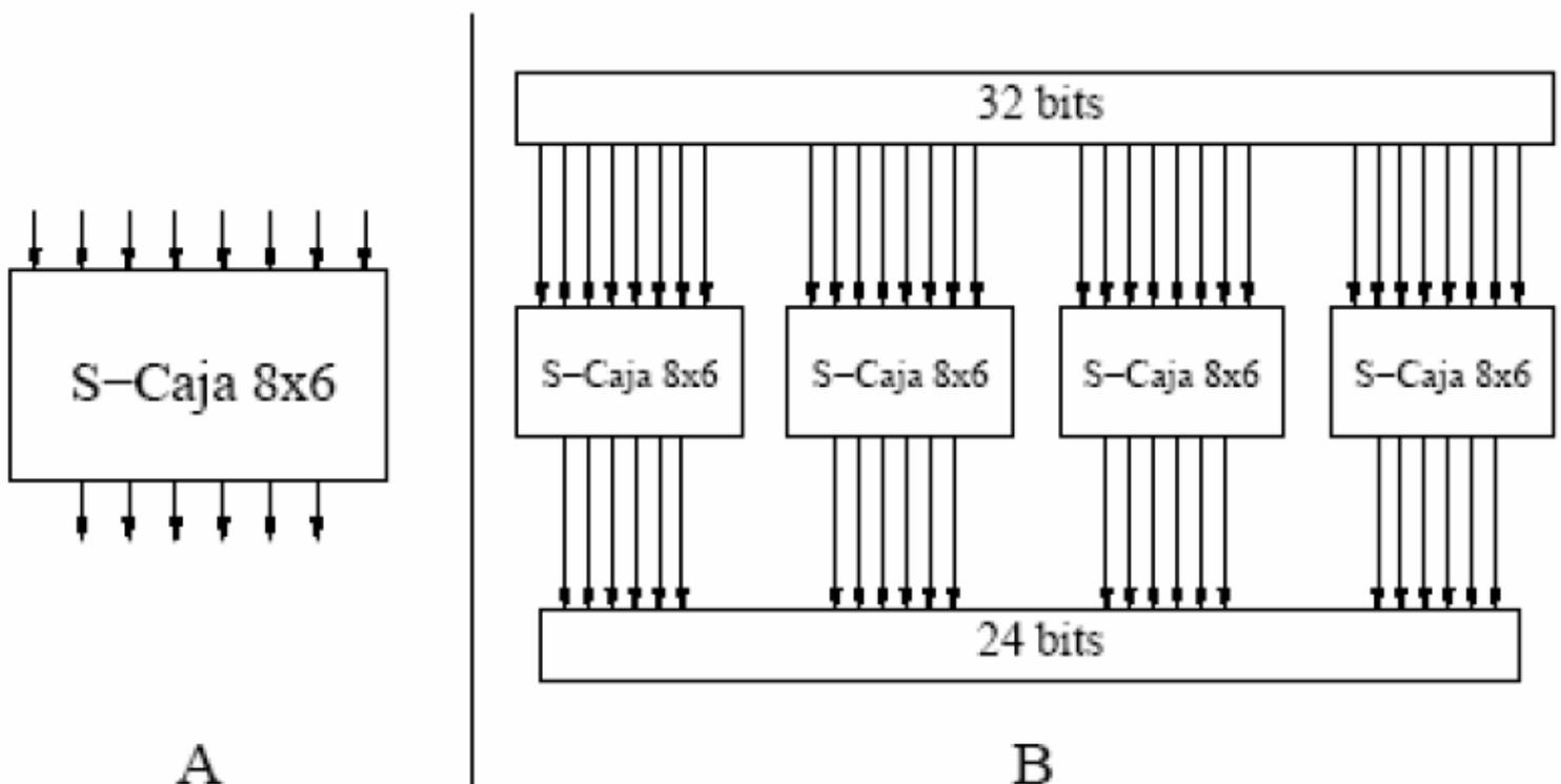
DES emplea ocho S-Cajas de  $6 \times 4$  bits. La utilización de las S-Cajas es sencilla: se divide el bloque original en trozos de  $m$  bits y cada uno de ellos se sustituye por otro de  $n$  bits, haciendo uso de la S-Caja correspondiente. Normalmente, cuanto más grandes sean las S-
