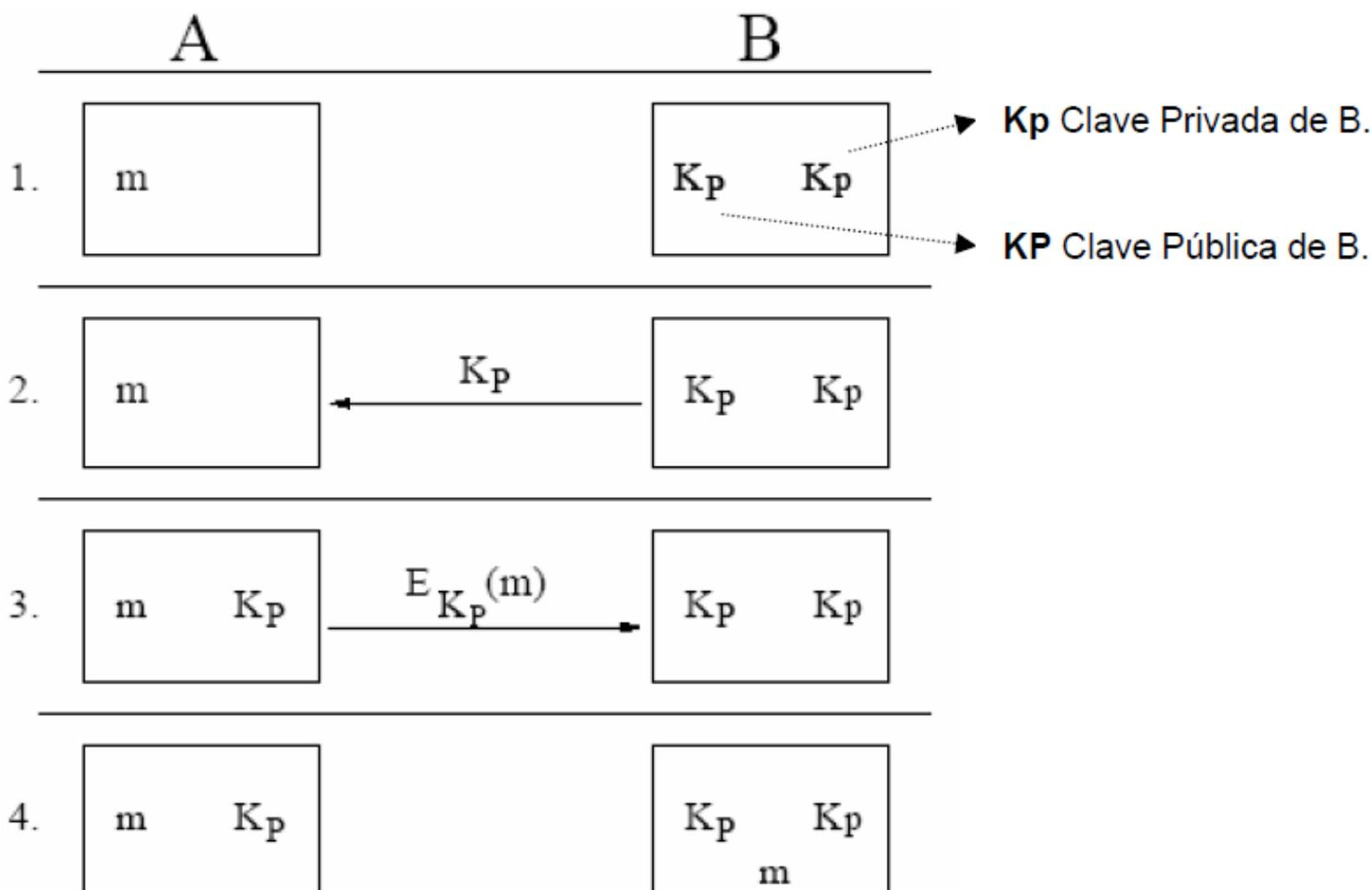
Expresado de manera formal, tal como muestra la figura, el proceso de transmisión de información empleando algoritmos asimétricos es el siguiente:
