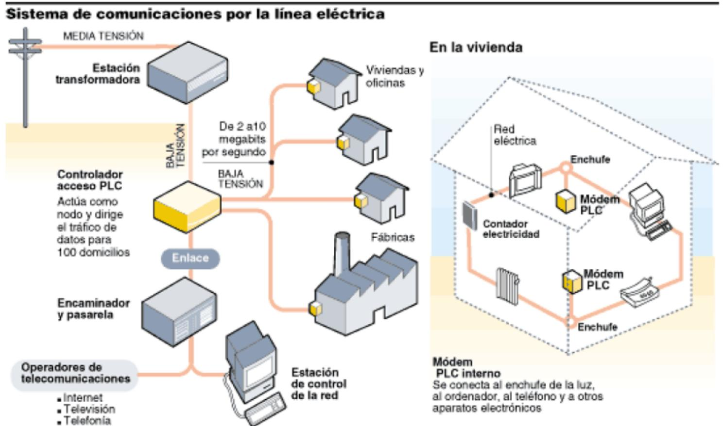
La red eléctrica transporta electricidad a una frecuencia de 50 Hz. En PLC se añaden frecuencias en la banda que va desde 1,6MHz hasta 30MHz para el transporte de los datos. Unos filtros instalados en el transformador de baja tensión separan las frecuencias altas de datos, de la frecuencia de 50Hz de la electricidad.
