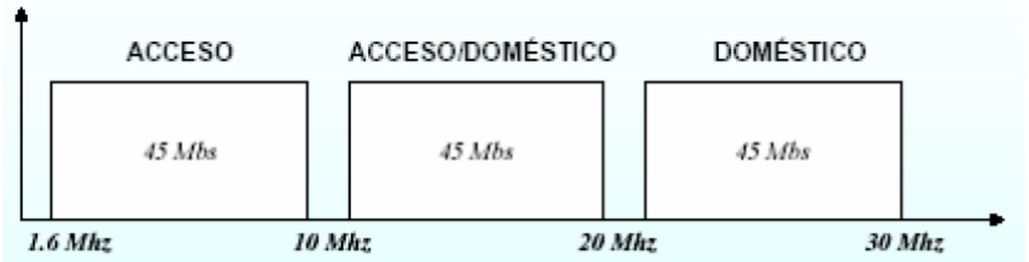
Power Line emplea una red conocida como High Frequency conditioned Power Network (HFPCN) para transmitir simultáneamente energía e información. Una serie de unidades acondicionadoras son las que se encargan del filtrado y separación de ambas señales.
