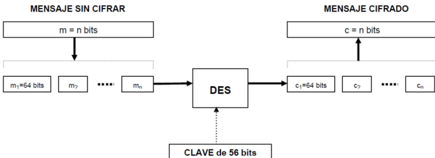
*Funcionamiento específico del algoritmo DES.*
