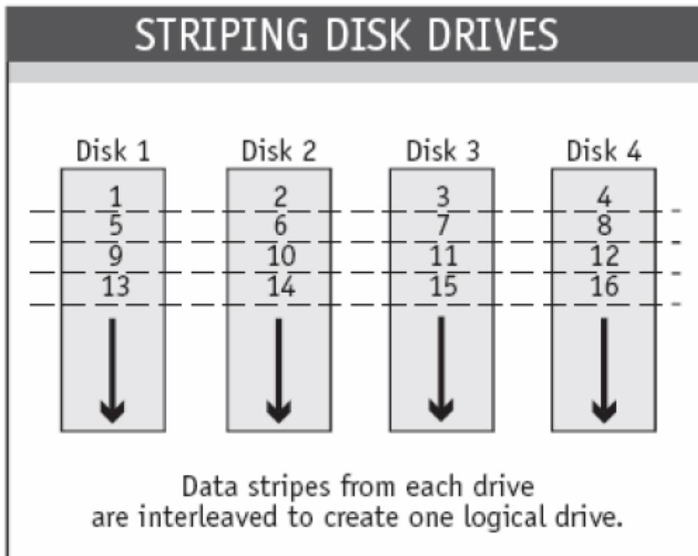
Creando los discos del array con stripes lo suficientemente grandes para que un registro entre enteramente en un solo stripe, la mayoría de los registros se pueden distribuir entre todos los disco. Esto hace que los discos del array se mantengan ocupados en situaciones de fuerte carga. Con ello se consigue que los discos trabajen de forma concurrente en operaciones de E/S, maximizando así el número de operaciones simultáneas de E/S que se pueden llevar a cabo en el array.
