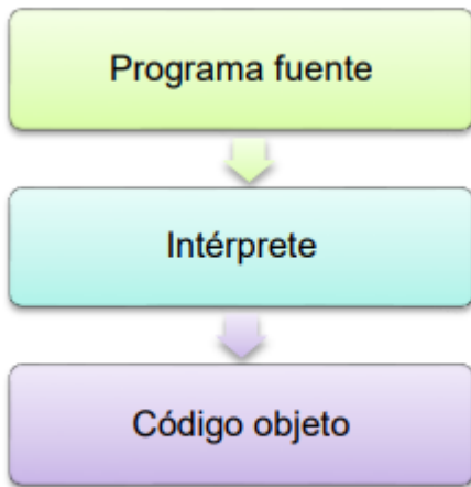
Funcionamiento de un intérprete
